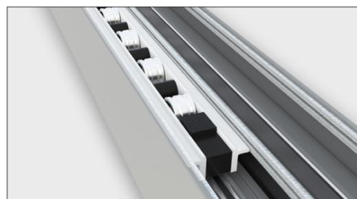
Chaque vantail coulisse sur deux chariots. Afin de limiter l'effort à l'ouverture, chaque chariot est équipé de quatre paires de roulettes en acier inoxydable de qualité marine qui coulisent sur un double rail en acier inoxydable capable de supporter jusqu'à 500 kg. Les systèmes de roulement à 8 roulettes peuvent supporter jusqu'à 1 200 kg. Il est recommandé de motoriser les vantaux dont le poids dépasse 500 kg
