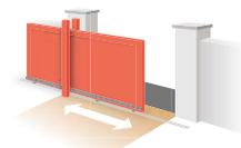
Moteur intégré dans le poteau de guidage
